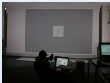
Abb. 2: Versuchsperson in der Bedingung „kleine Fläche“. Der Testreiz ist der kleine Kreis in der Mitte des hellen Quadrats. Das Umfeld des Kreises entspricht dem Umfeld der großen Projektionsfläche. Auf dem VP-Monitor ist die CIELab-Farbkarte zu sehen.
